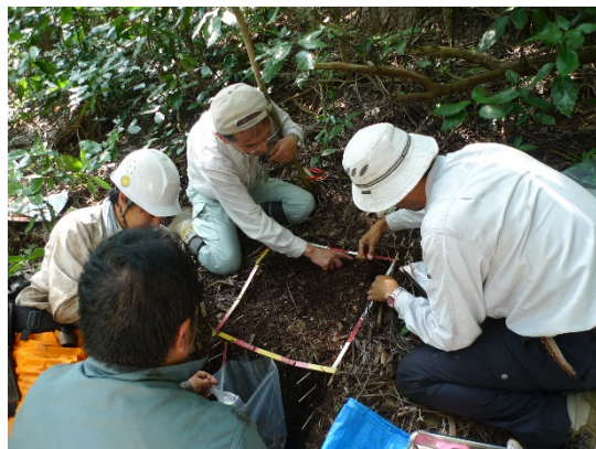
堆積有機物の採取。L/F の見分け方や F 層を正しく採取することの重要性を指摘。
