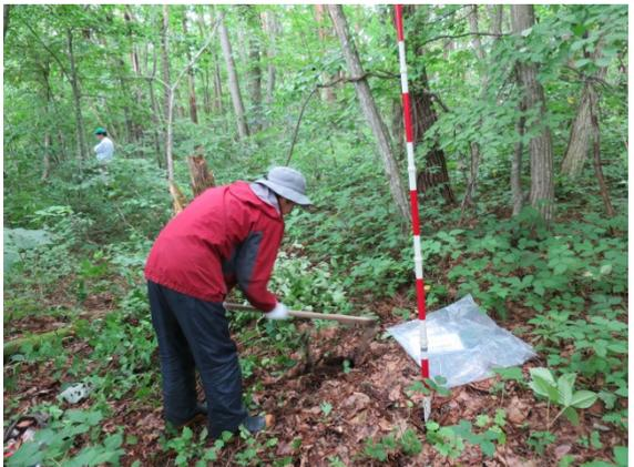
荒掘りの際、堆積有機物の採取予定の場所にビニル袋をかけて、土が混じらないよう工夫していた。
