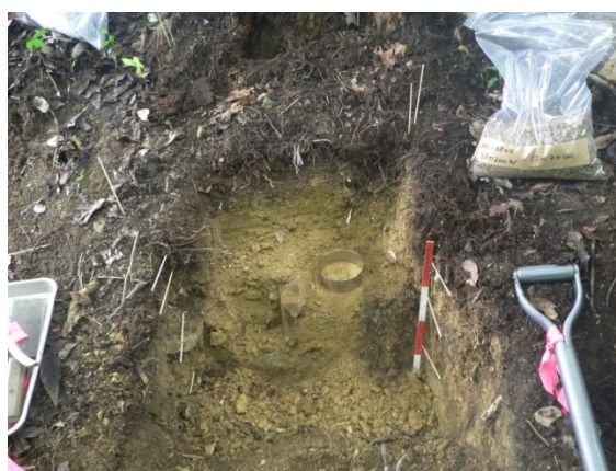
写真4. 尾根地点の土壌円筒の採取途中。風化した礫が多く、円筒試料、化学性試料の採取にかなり手間取った。
