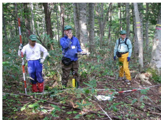
写真2. 水平距離の測定。巻き尺、クリノメーターを用いて、斜距離と傾斜角を測定する。
