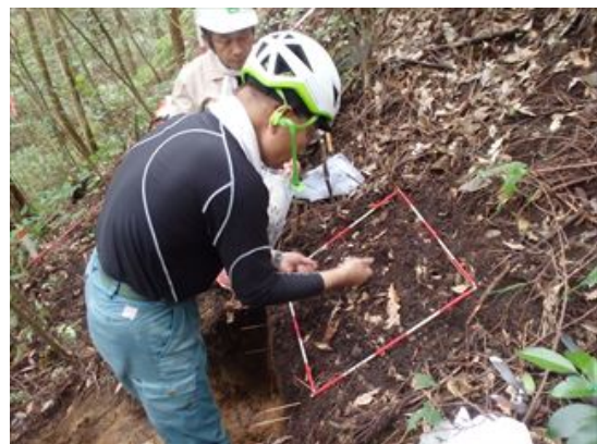
写真4. 堆積有機物の採取。礫や土が混入しないよう、堆積有機物だけつまみ上げる。
