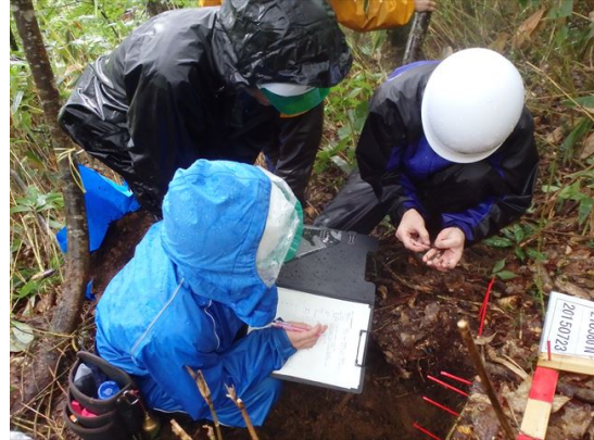
写真2. 1日目。H層とA層の判定は難しいので、手触りで確かめる。
