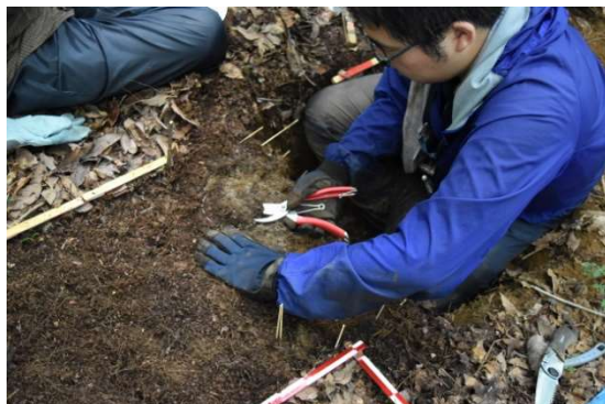
土壌炭素蓄積量調査（定体積試料の採取）
