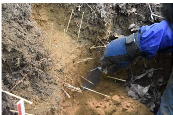
土壌炭素蓄積量調査（化学分析用試料の採取）
