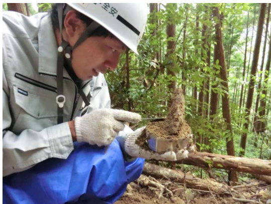
採土円筒による定体積試料採取
