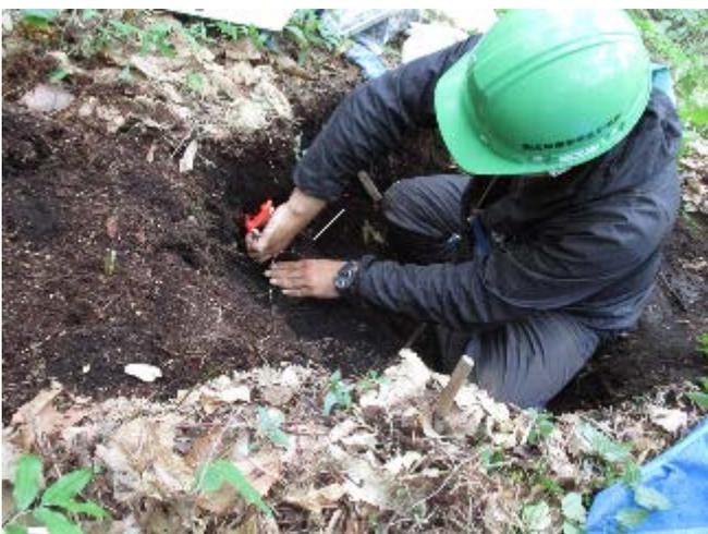
写真7 定体積試料の採取
