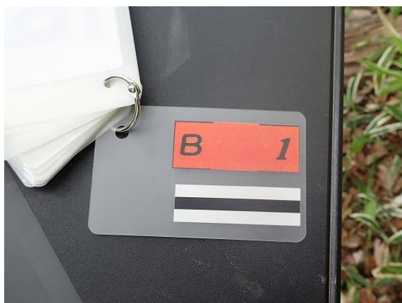
番号札と印刷した基準尺を マットフィルムでラミネートしたカード
