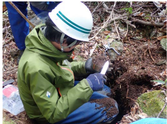
土壌の定体積試料の採取
