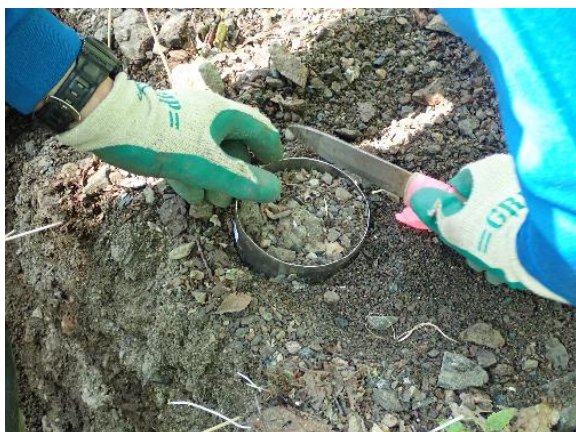
円筒を用いた定体積試料の採取 (W 地点)
