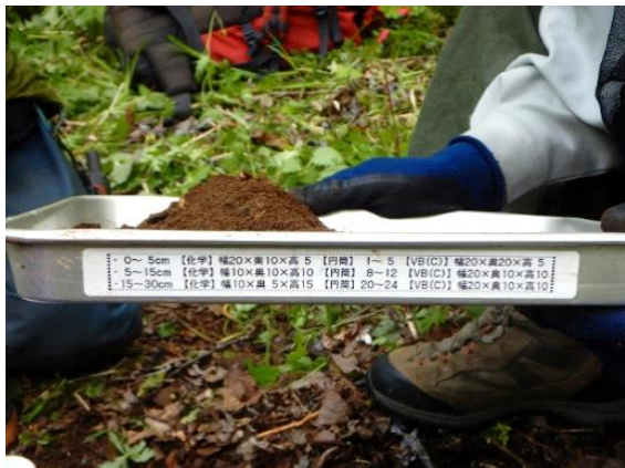
土壌試料の採取深度とサイズをラベルに 印字し、側面に貼りつけたバット
