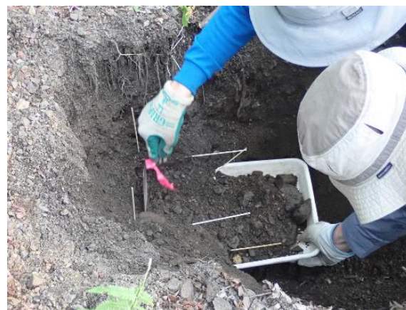
ブロックサンプリングによる 定体積試料の採取 (W 地点)
