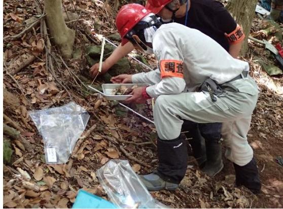
写真4 堆積有機物層の採取
