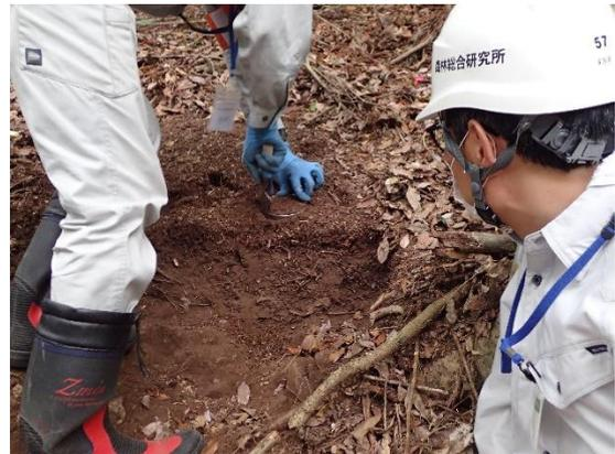
写真6 定体積試料の採取
