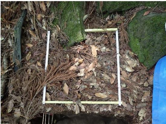
写真11 大きな礫があり堆積有機物採取枠が地表に接地できない場合の設置例
