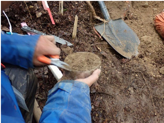
採土円筒による定体積試料の採取
