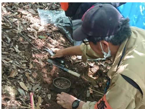
写真5 円筒によるサンプリング
