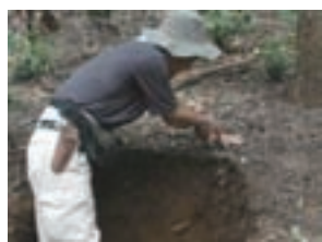
9. 掘削面より約 10cm 奥を整形面とする。落葉落枝は鋏で切る
