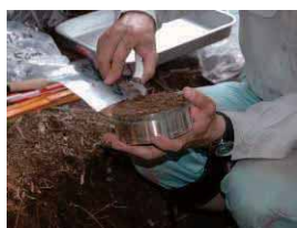
8)-2 円筒の縁からはみ出た土、礫、根を削り、平坦にする。
