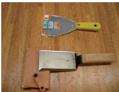
e) 土壌断面成型用コテ (下) とスクレーパー
