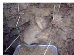
10) ブロック内の土壌は全量採取。石礫が大きい場合には隙間の土壌を集める。
