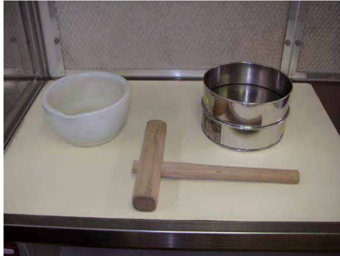
写真 C 1 土壌試料調整用器具（乳鉢（左上）、円孔篩（右上）、木製杵（中央下））
