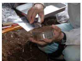
9)-2 円筒の縁からはみ出た土、礫、根を削り、平坦にする。
