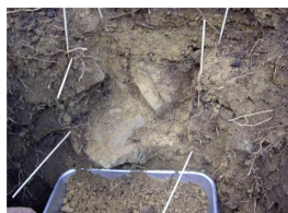
11) ブロック内の土壌は全量採取。石礫が大きい場合には隙間の土壌を集める。
