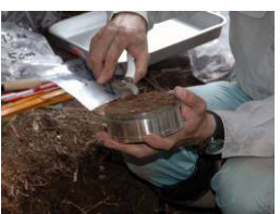
9)-2 円筒の縁からはみ出た土、礫、根を削り、平坦にする。
