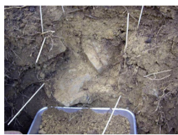
11) ブロック内の土壌は全量採取。石礫が大きい場合には隙間の土壌を集める。
