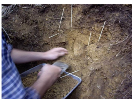
10) ブロック試料は竹串で採取する大きさの目印を刺す。
