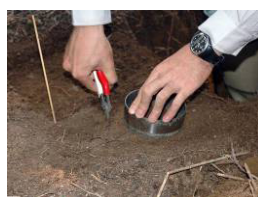
9)-1 定体積試料の採取。刃を下に、手は常に円筒を支え、根を切りつつ入れる。
