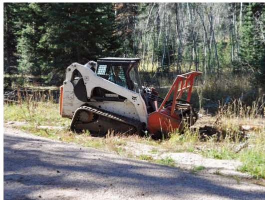
写真-9 小径木をチップ化する小型の林業機械
