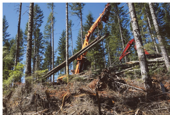
写真-5 ヨルダーシステム。スラックブリッジシステムの一つ。ベースマシンは Jewell 社 DX330LC 型、搬器は ACME 社
