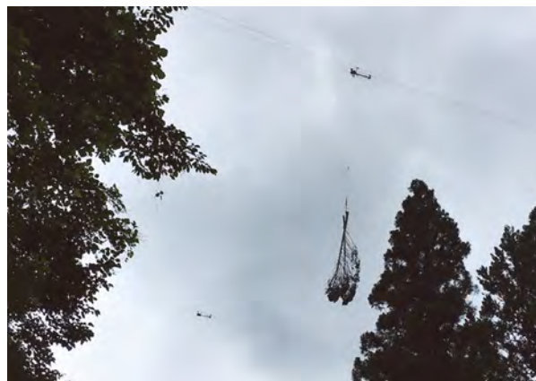
写真-7 中土佐町間伐作業現場でのH型架線集材
