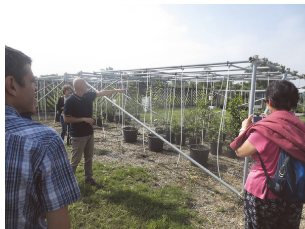
写真-4 開放系オゾン付加施設 濃度を 2 段階に調整できる
