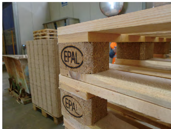
写真-2 木質廃材から製造したパレットブロック（Ecobloks）
