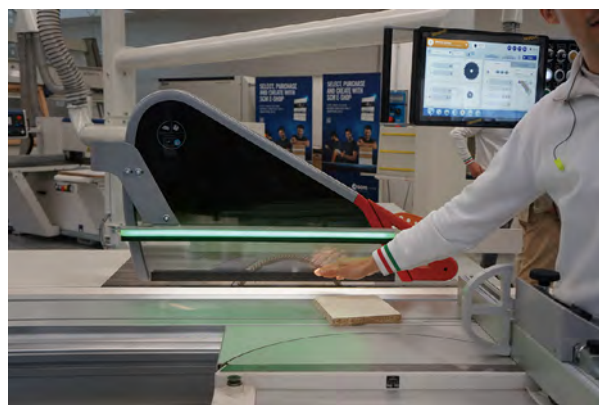
写真-3 高度な安全機能を備えた丸鋸盤（SCM）
