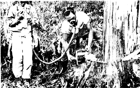
写真 13. 伐倒の R.M.R. 測定 (マツカラー)
