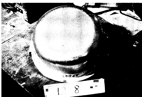
ナベ底の汚損状況 (白炭カシ 無処理 東京都五日市町産) Phot. 53 Stain of pan's back by volatile ash
