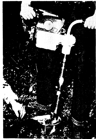
Photo. 7 手持式1人用植穴掘機 One-man portable earth drill. Mc Culloch Co. 製 (アメリカ) エンジン 3 PS, 自重 12 kg, 刃回転数 480 rpm
