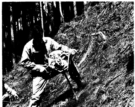
Photo. 15 DR III 形機による植穴掘り 於東京都下 奥多摩古里, ヒノキ伐採跡 35° 斜面 (Mar. 24/1961) Digging of holes for tree-planting by using DR III type earth drill.
