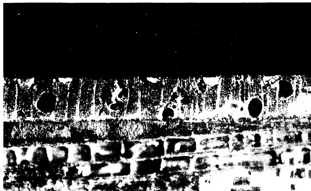
Photo. 4 表板の薄い合板：裏割れが進行し表面に貫通している，裏割れが髄線割れに連なっている。(合板塗膜割れ試験における乾湿繰り返し 25 cycle 後) Cross section of after 52 cycles dry and wet test of a plywood specimen assembled with the thin face veneer. The lathe checks proceed through the face veneer and are jointed with pith ray cracks.
