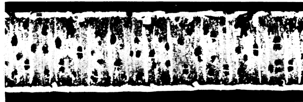
a 单板 a—veneer 裏割れ率 Percentage of lathe check 10~25% 面粗さ (凸部) Roughness 最大値 max. 0.053mm 平均値 max. 0.090mm 試料採取位置 Sampling position 20 回転目 the 20th rotation
