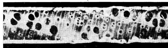
付図 4. ノーズバー引上げ角度を変化させた場合の裏割れ 樹種 シオジ 60°C 24 hr 処理材
