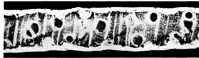
付図 13. ノーズバー引上げ角度を変化させた場合の裏割れ 樹種 レッド ラワン 無処理材
