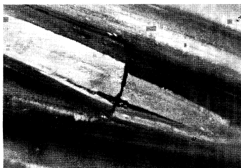
写真 5. 往復回数 3 万で発生した山断線
