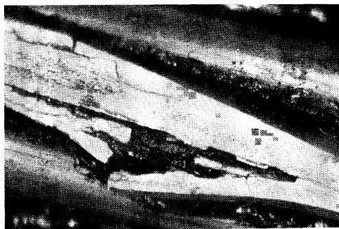
写真 6. 塑性変形した箇所への崩壊現象
