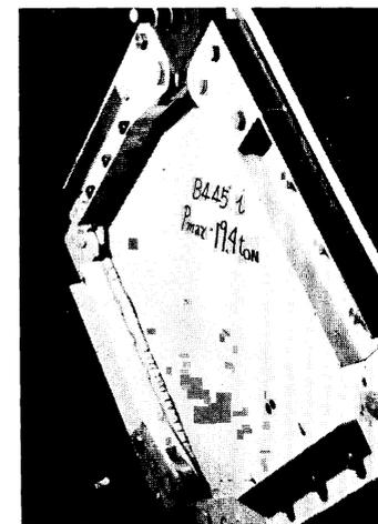
Photo. 2-24 ラワン合板 (12mm) (45°) 面の逆剪断による剪断座屈破壊状態 (L 12B 合板)
