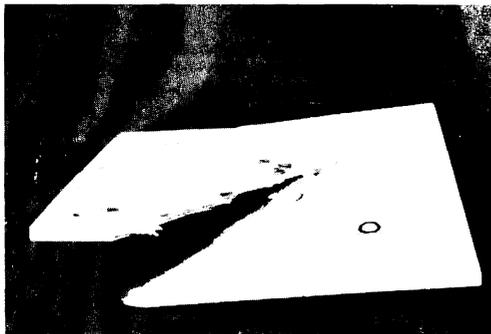
Photo. 2-46 ヤチダモ合板 (15mm) の (45°) 面のプレート剪断による破壊状態 (T15合板)
