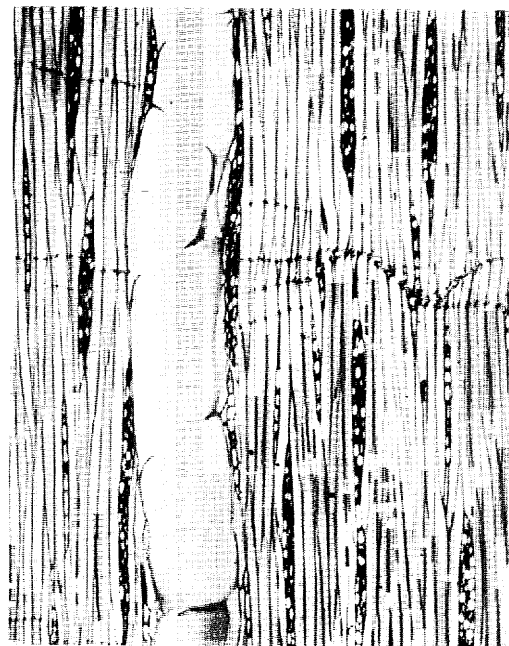
Photo. 8. IXA-1 × 50 フリットルハートの圧縮破壊を示す 樹心から 5 cm
