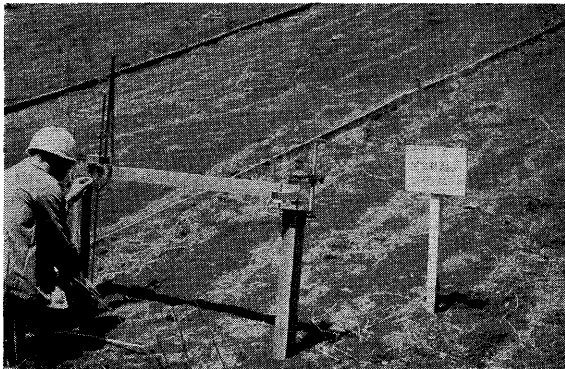
Photo. 9 林試東北型土壌侵食計 The Rinshi-Tohoku type erosion gauge.
