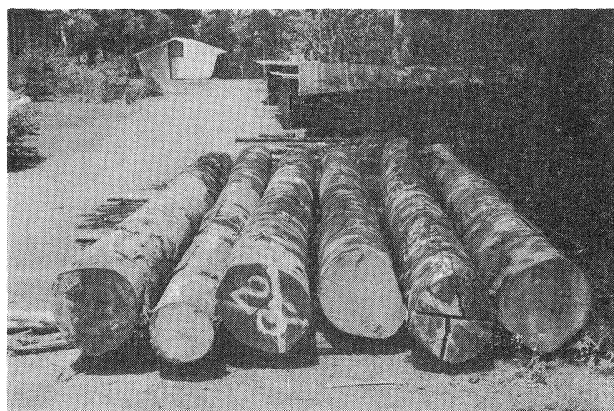
Photo. 2 スポンジアスの木口割れ (右から2番目) Endsplit of Spondias (The second log from right).
