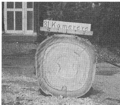
No. 222 カメレレ Eucalyptus deglupta (Myrtaceae) 不規則な濃色の筋が入る Wood with irregular dark streaks.
