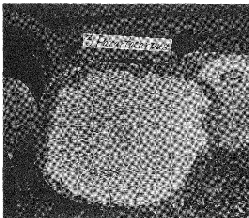
No. 213 パラルトカルプス Parartocarpus venenosus (Moraceae) 辺・心材の区別が不明で、周辺部は著しく青変する Heartwood not distinct and outer part severely blue-stained.
