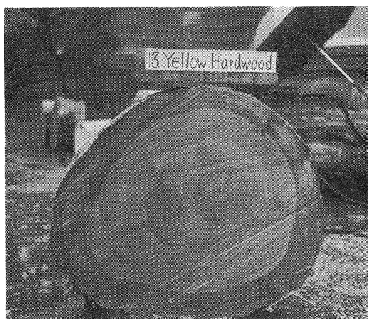
No. 215 イエローハードウッド Neonauclea maluensis (Rubiaceae) 新鮮なこの状態では辺心材の境は明瞭であるが、乾いた材では不明瞭になる Heartwood and sapwood distinct in this fresh condition, the demarcation becoming rather indistinct later.
