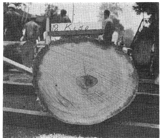
No. 212 ダイゾックス Dysoxylum arnoldianum (Meliaceae) 周辺部著しく青変し、中央部は濃色 Wood with blue-stained outer part and dark center.
