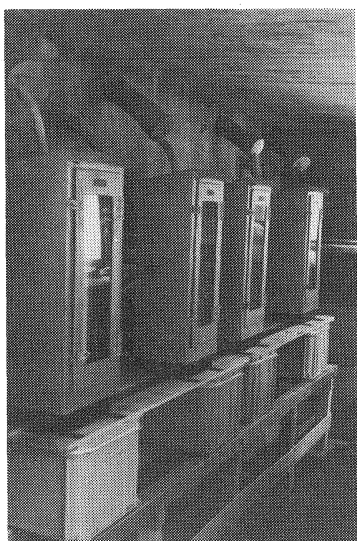
Photo. 2 斜面ライシメーター の地下観測室 Observation room.
