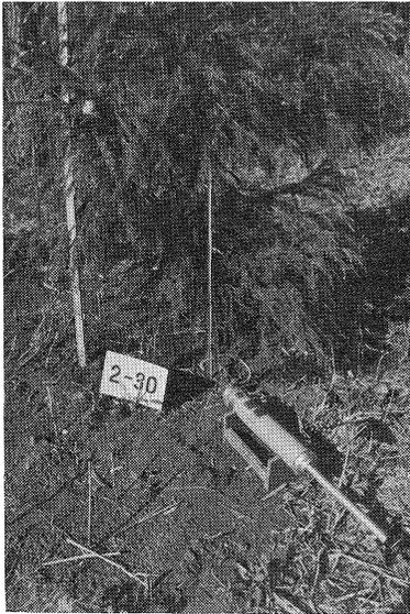
Photo. 北川式検知器によるCO<sub>2</sub>の測定
