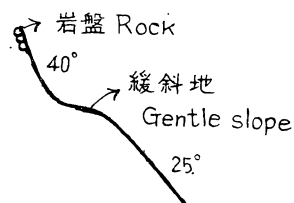
Fig 7. 崩壊後の断面 Section after slide
