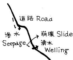
Fig. 4. 道路による崩壊 Slide due to road
