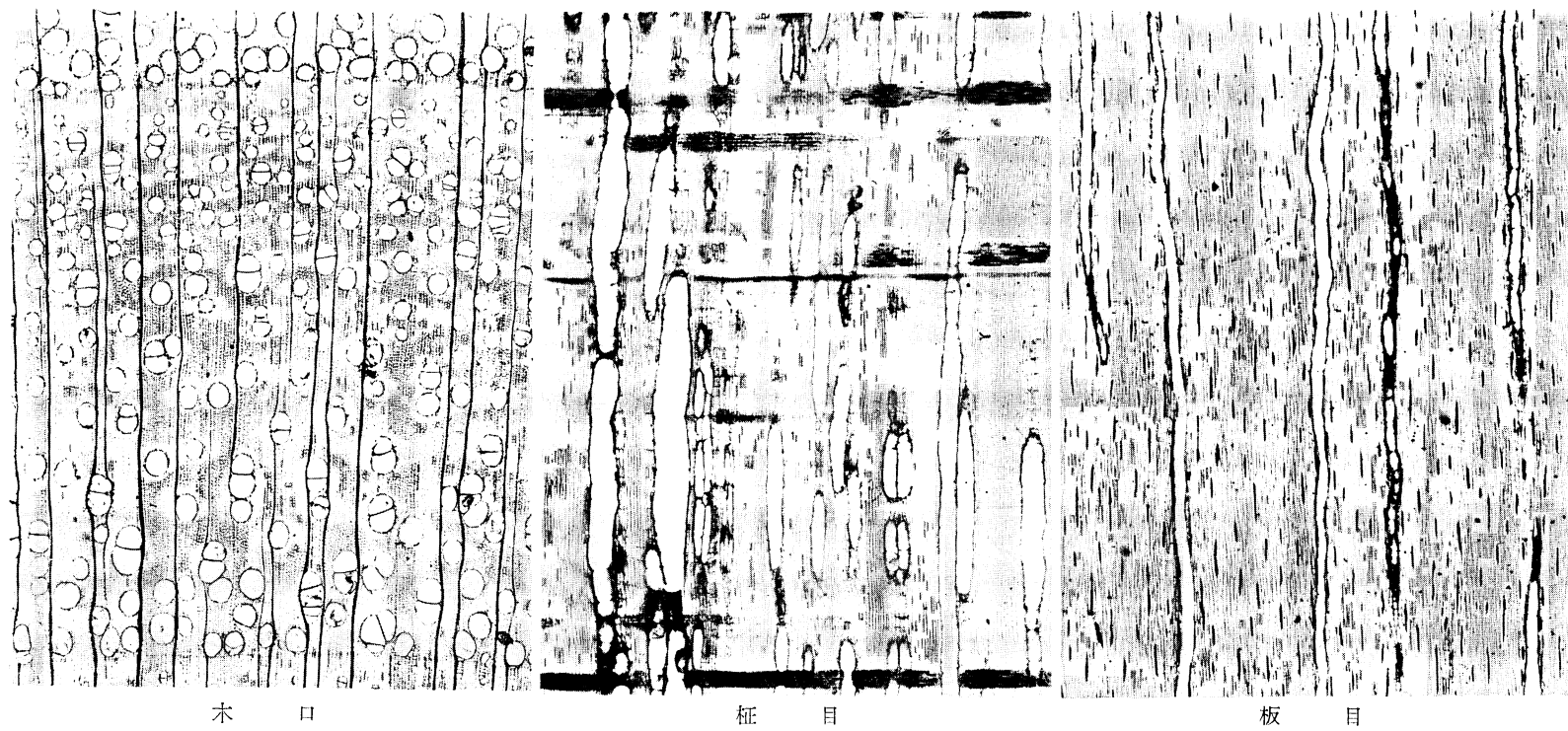
第 11 図 九重キリの顕微鏡構造 (10×)
