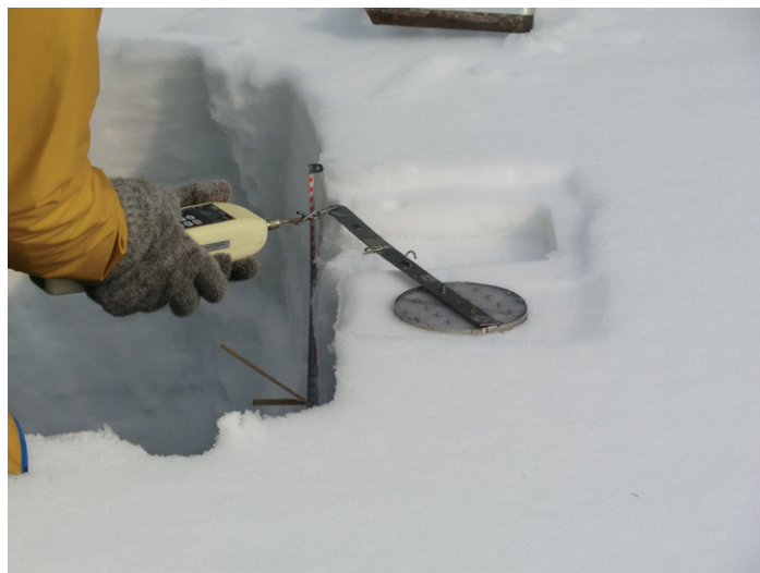
写真 10 積雪のせん断強度の測定.
