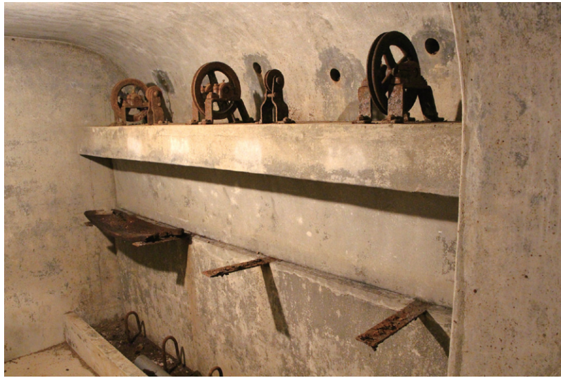
図2 十日町試験地の地下道に残る斜面積雪の移動量測定装置（村上，2017）
