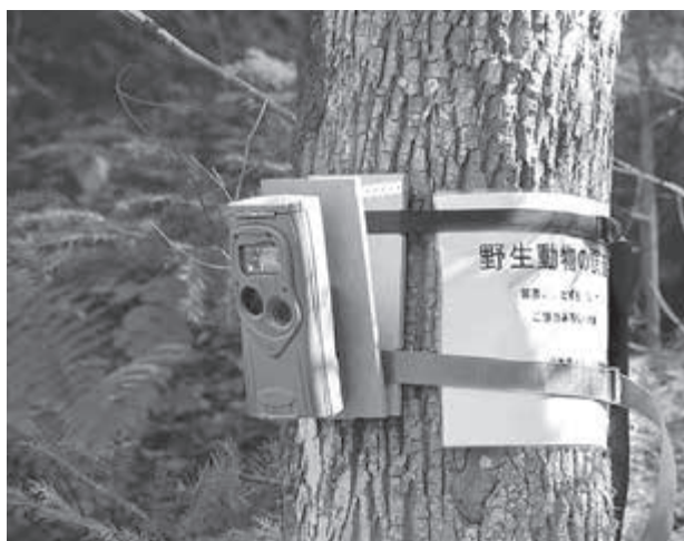
写真-1 使用機材(Ambush, Cuddeback, Green Bay, WI) および設置方法
