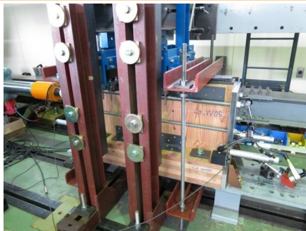
L形せん断金物試験 ＜壁と床の接合＞
