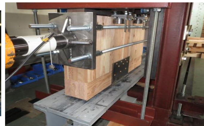
U形せん断金物試験 ＜基礎と壁の接合＞
