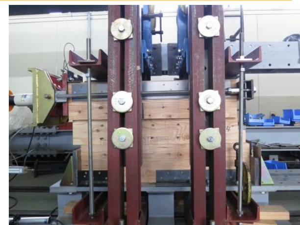
スプライン接合試験 ＜床と床の接合＞
