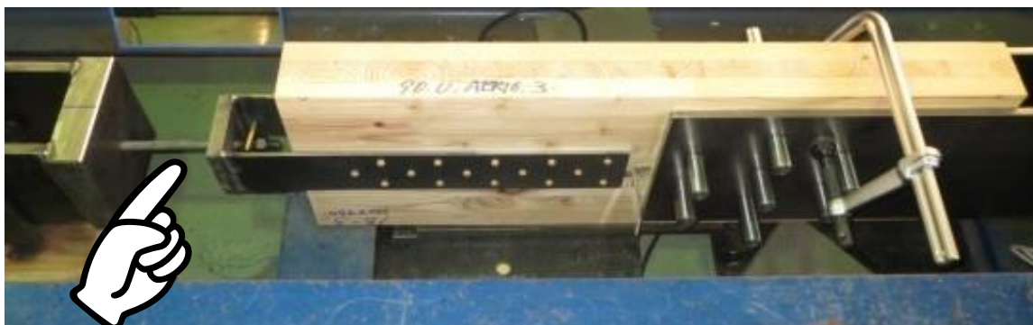
U形引張金物試験 ＜基礎と壁の接合＞
