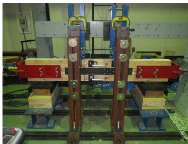
帯金物試験 ＜1階壁と2階壁の接合＞
