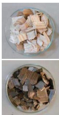
図1. 無処理木材チップ（上）と 半炭化木材チップ（下）
