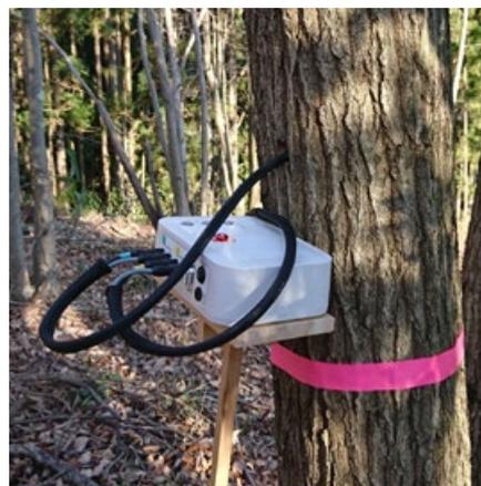
図2 樹木の放射性セシウム濃度を現場で測定できる検査装置
