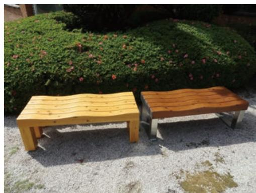
図3 CNF配合塗料を下塗りに用いて塗装した木製ベンチ
