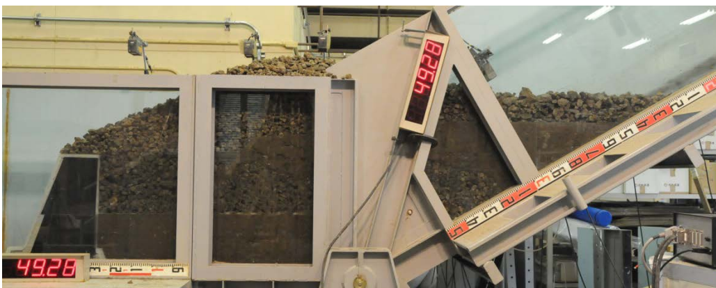
参考写真2 水分を減らした不飽和の軽石堆砂を背後に有した治山ダムが流下土砂を捕捉した状況
