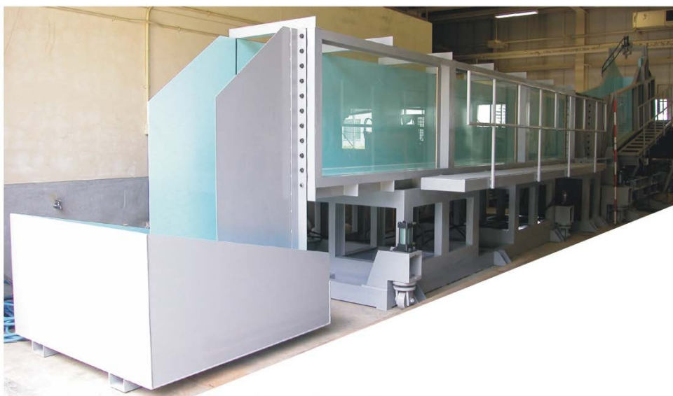
写真1 土石流実験に使用した大型水路の全景
