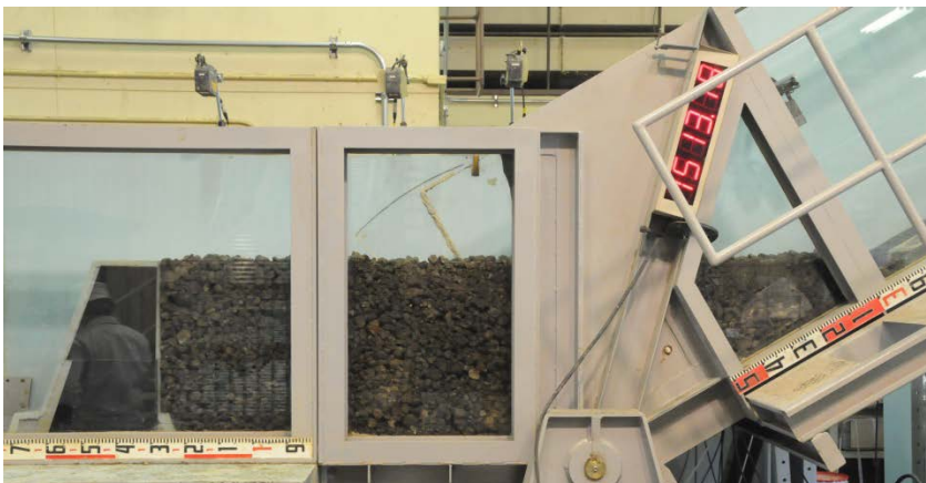
参考写真1 治山ダム模型の背後に水分を減らした不飽和の軽石堆砂を与えた状況
