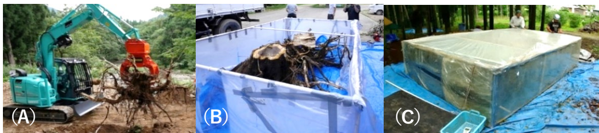
図1. (A) 根全体を重機と人手で徹底的に採取、(B) 全ての根を測定装置に入れる、(C) 密閉後の呼吸測定 芽生え～成木に対応した大小10個の装置を作成し、内部に材料を密閉しCO 2 濃度上昇を直接測定することで呼吸を評価します。再現性は高く、正確な測定ができます。測定は夏に行い、呼吸は同じ温度条件で比較します。
