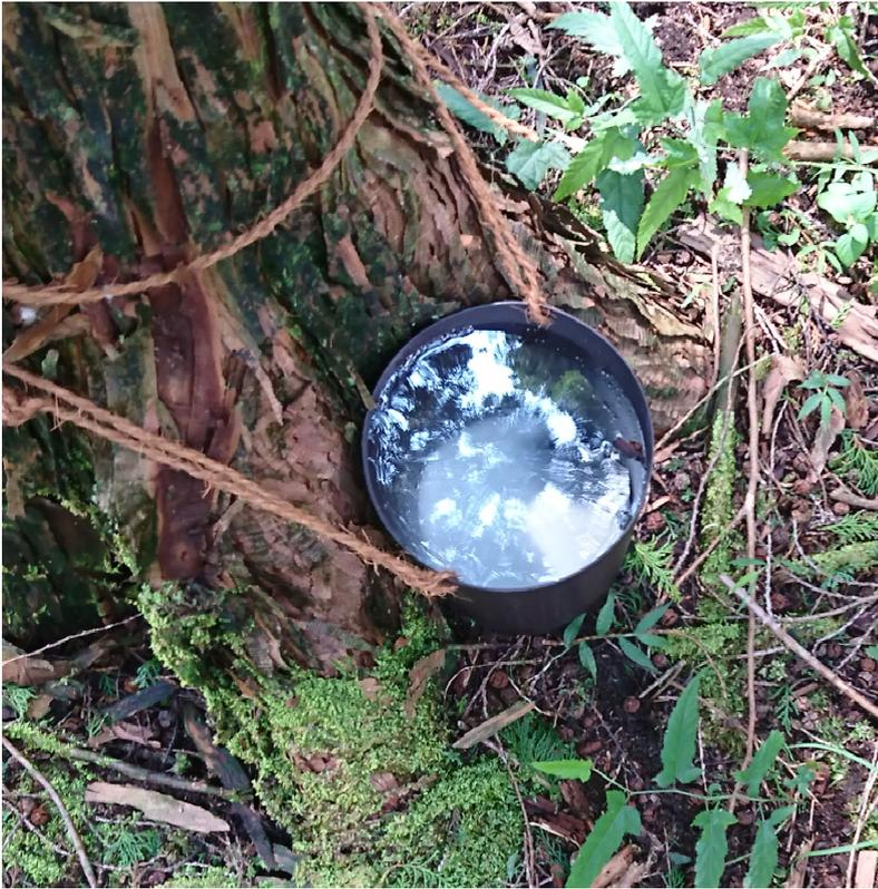
図 1. 塩水の設置方法。バケツに約 900g の食塩と 2 ℓ の水を入れます。
