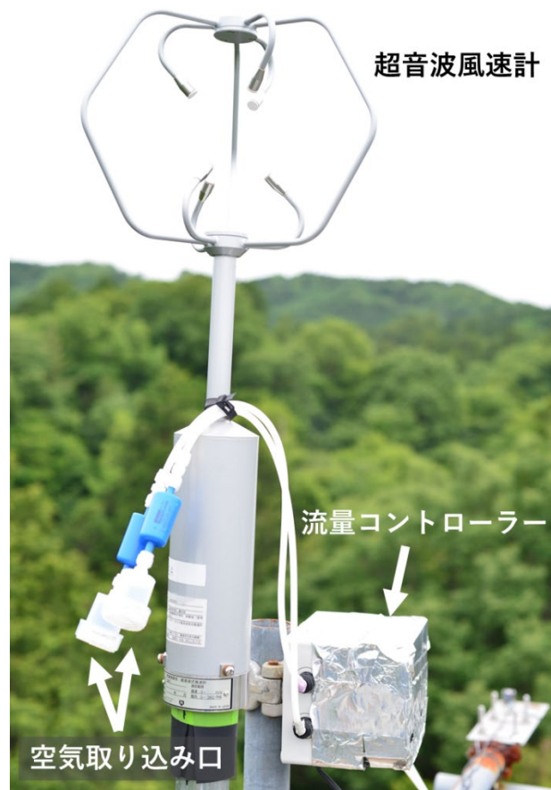
図1 滋賀県南部の森林観測タワー（高さ 29m、桐生水文試験地）に設置された真の渦集積法（TEA 法）に基づく大気サンプリングシステム。超音波風速計が捉える空気の上下の動き（鉛直風速）に応じて、上昇流と下降流を分離・採取する。
