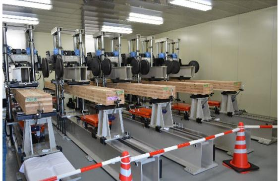
直交集成板長期挙動実験棟(次世代木造建築実験棟)(森林総合研究所(つくば))
